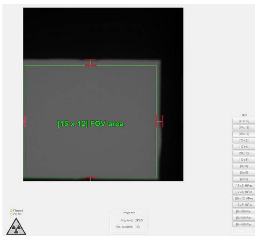
Figure 8 : Test du collimateur
