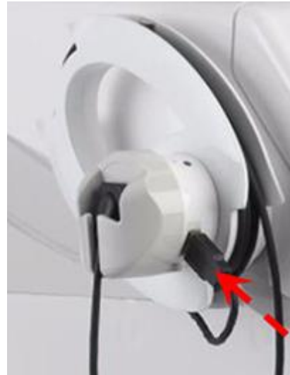
Den Sensor an die an der Behandlungseinheit integrierte Schnittstelle anschließen (an der Behandlungseinheit integrierter Sensor)
