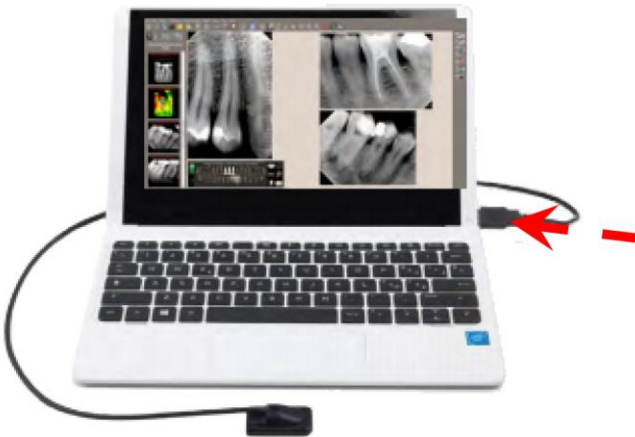
Den Sensor an den USB®-Anschluss des Personal Computers anschließen (stand-alone Sensor)
