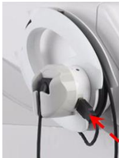
Conectar el sensor a la interfaz integrada en el equipo (sensor integrado en el equipo)
