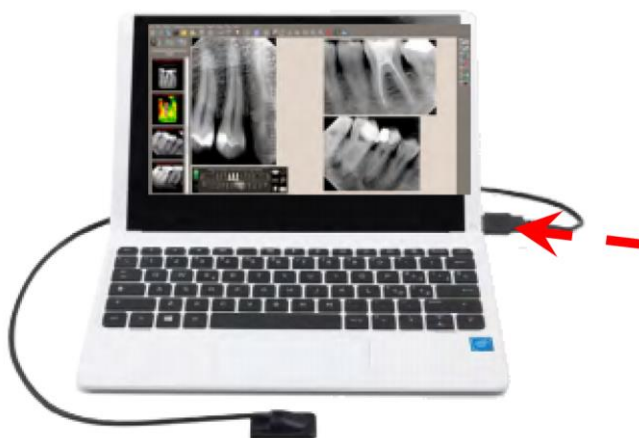
Conectar el sensor al puerto USB® del ordenador (sensor stand-alone)
