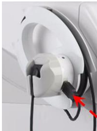
Connettere il sensore all'interfaccia integrata a riunito (sensore integrato a riunito)
