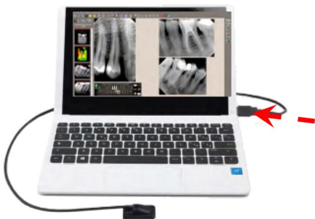
Connettere il sensore alla porta USB® del Personal Computer (sensore stand-alone)
