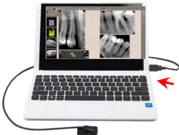
Connettere il sensore alla porta USB® del Personal Computer
