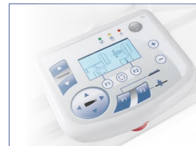
La console sur la machine offre une interface intuitive avec laquelle il est possible de déplacer facilement la table sur les trois axes et activer les lasers de centrage, en identifiant les repères exacts de la zone à examiner.
