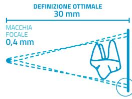
Aumento del parallelismo dei raggi X e collimatore incorporato consentono a RX DC VET di raggiungere una distanza fuoco-pelle di 30 cm. RX DC VET ti permette di avere immagini nitide, precise e grande livello di dettaglio.
